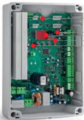
2 alojamentos para **placas de acoplamento** de comando e de segurança por rádio (faixas de segurança com controlo automático, detetor com espiral magnética, decodificador para seletor RFID)
