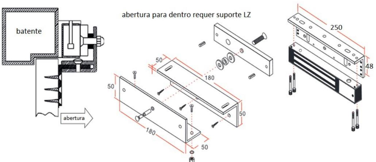
**Suporte AA-L280 para Montagem da Chapa de Atraque em portas que abrem para fora
