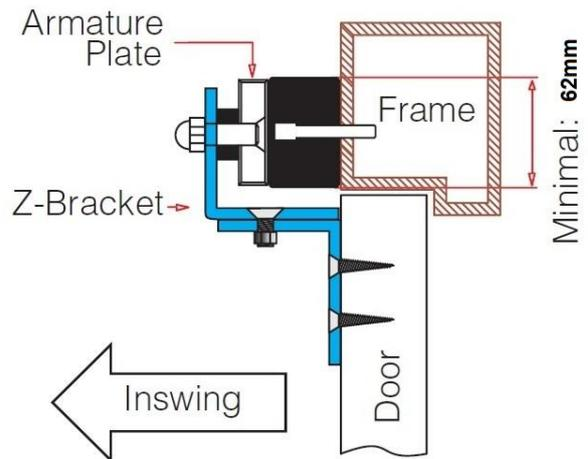
**Esquema de Montagem Frontal com Suporte Z-500N para portas que abrem para dentro**
