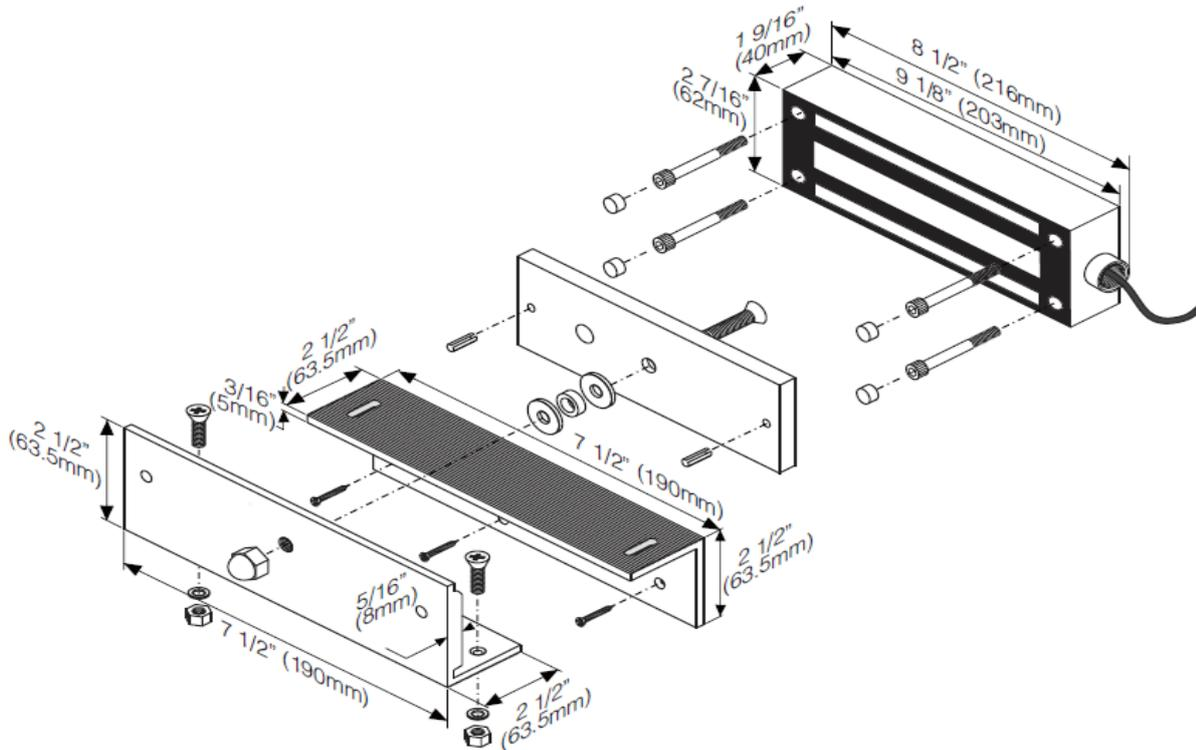
**Esquema de Montagem Frontal com 2 x Suportes L-1200 em portões de correr**
